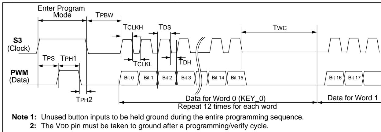
**FIGURE 6-2: VERIFY WAVEFORMS**
